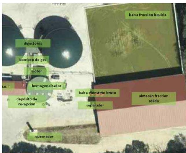
Esquema funcionamiento planta biogás
