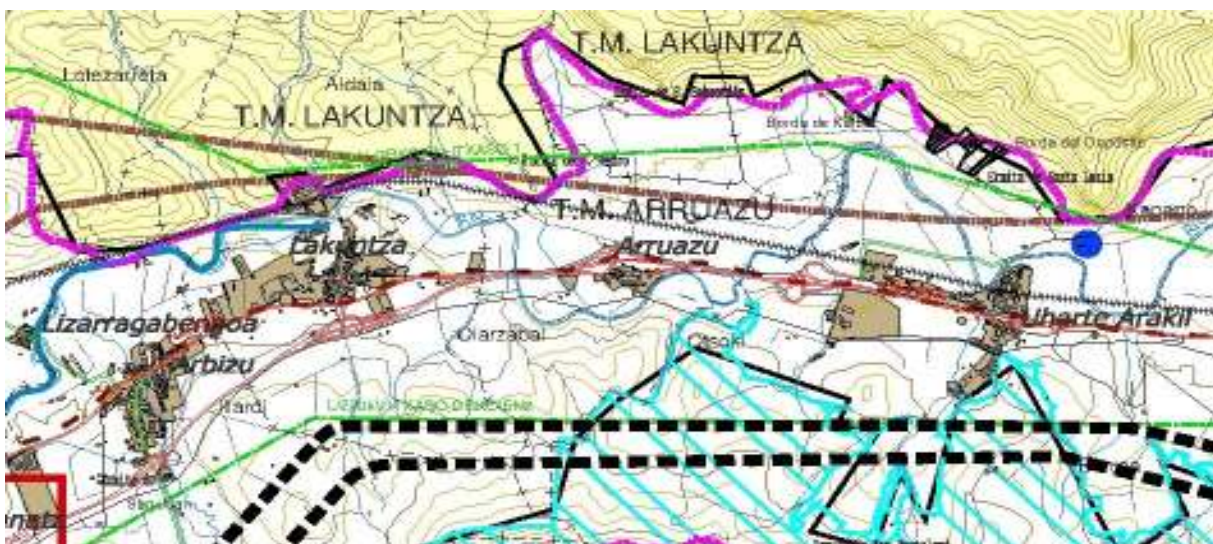
Plano de la proyectada línea eléctrica de alta tensión a 400 kV entre Dicastillo e Itsaso a su paso por Arakil (líneas discontinuas negras). En la imagen se aprecian también las 2 líneas eléctricas a 220 kV existentes (en verde), así como el trazado del TAV (en marrón). Fuente: documento inicial de impacto ambiental de la línea Dicastillo - Itsaso.
