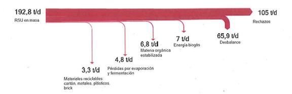
Entran de media 193 t/d de RSU en masa en la instalación
