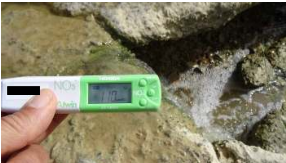
Medición in-situ de nitratos en el punto de control N° 2.
