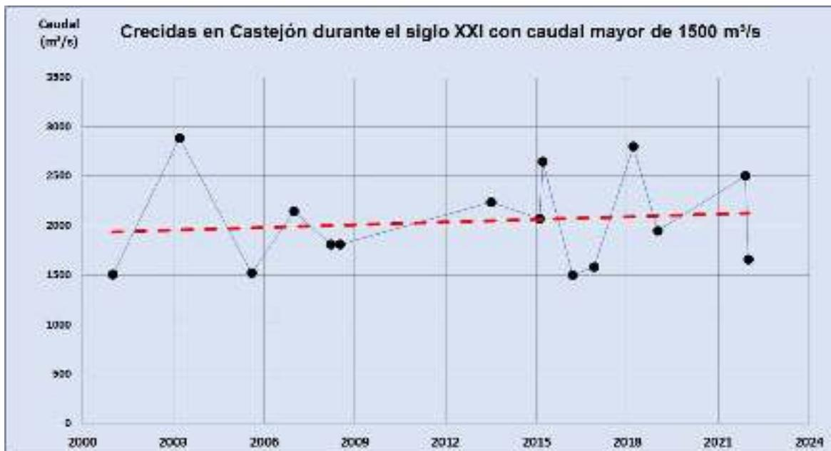
Figura 7. Seguimiento de los 22 años de siglo XXI en los 14 eventos sucedidos con caudales por encima de 1500 m³/s en Castejón, seis de ellos entre 2000 y 2011 y ocho de 2011 a 2022. A pesar de haber disminuido las precipitaciones, estos eventos crecen en frecuencia y en cantidad en torno a 100 toneladas de agua por segundo cada década.
